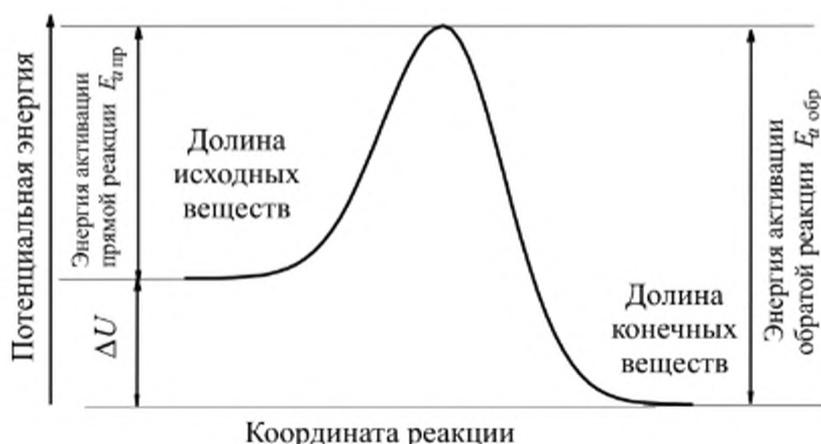
**Рис. 17.3.** Зависимость потенциальной энергии для невырожденной реакции при движении по координате реакции
