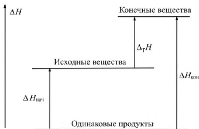
**Рис. 11.3.** Расчет тепловых эффектов по закону Гесса
