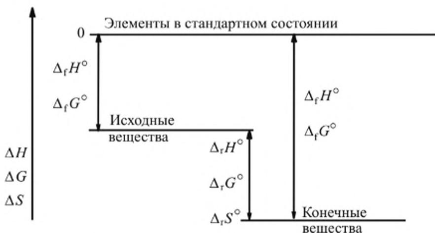
**Рис. 11.1.** Схема расчета термодинамических параметров химических реакций
